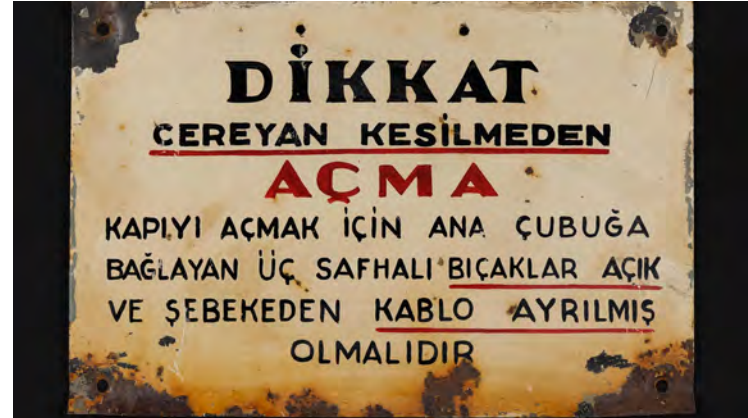
Şekil 12.4 Silahtarağa Elektrik Fabrikası'nda kullanılmış elektrik uyarılarından biri. "Dikkat. Cereyan kesilmeden açma. Kapıyı açmak için ana çubuğa bağlayan üç safhalı bıçaklar açık ve şebekeden kablo ayrılmış olmalıdır." Silahtarağa Arşiv.
